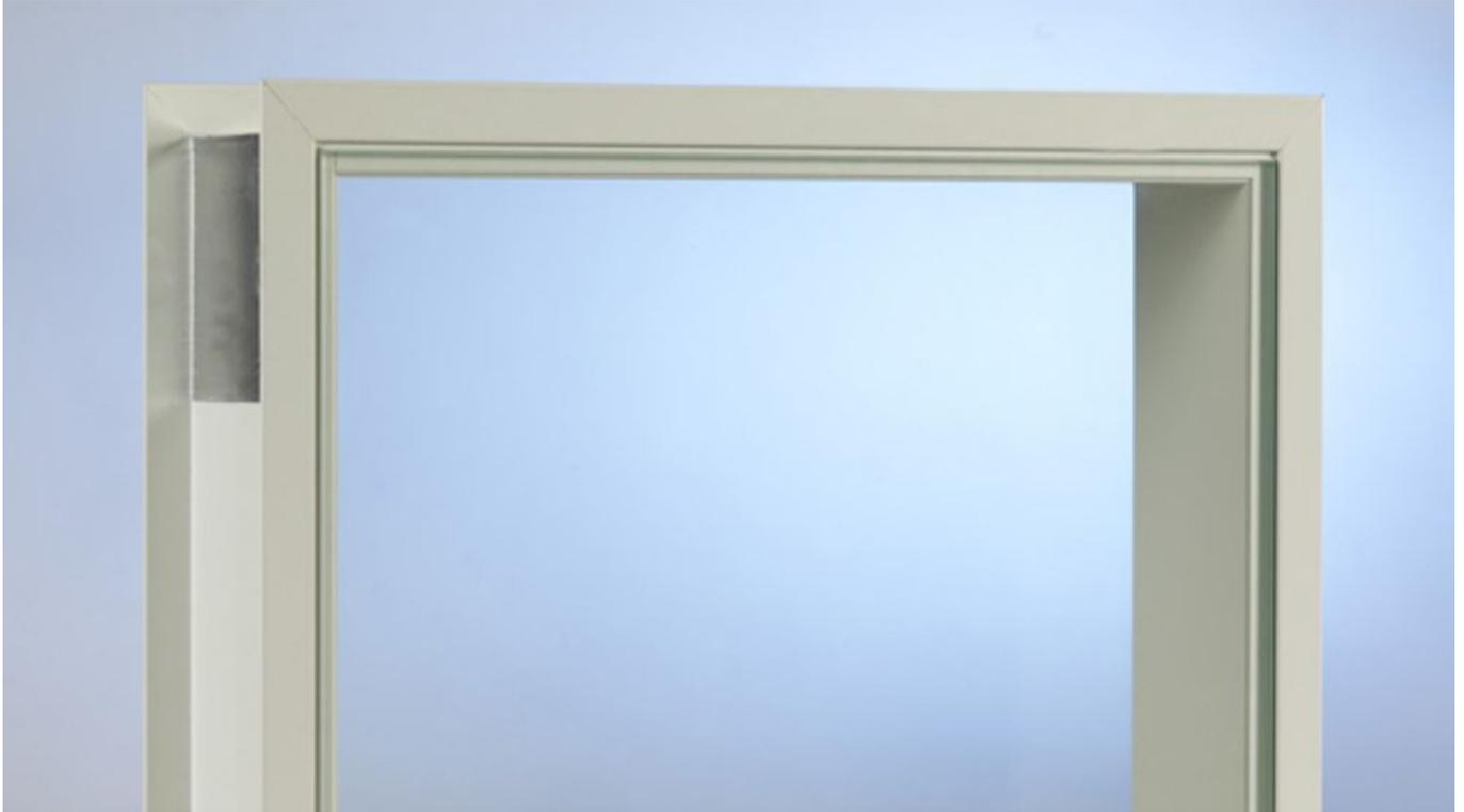
Les fenêtres en PVC sont faciles à installer sur des panneaux sandwich isolés. Elles sont constituées de profils en PVC blanc coloré dans la masse qui sont soudés dans les coins en onglet. Avec un même contre-cadre, les profils s'emboîtent **pour des panneaux sandwich de 60 mm d'épaisseur jusqu'à 140 mm d'épaisseur.**
